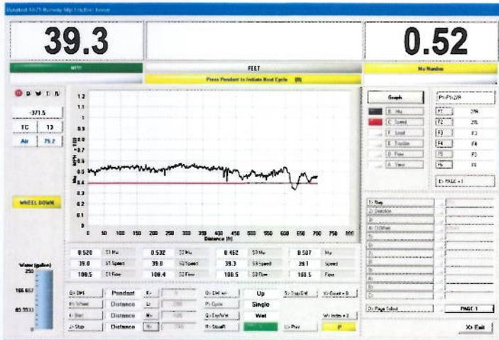
Que, en una computadora portátil se procesan de manera automatizada los datos de velocidad y distancia, así como la información de salida del transductor. El medidor de fricción de aeropistas 6875 puede ser operado fácilmente por una persona (el conductor). Además, se proporciona un asiento individual en el frente para un observador u operador. Sólo
